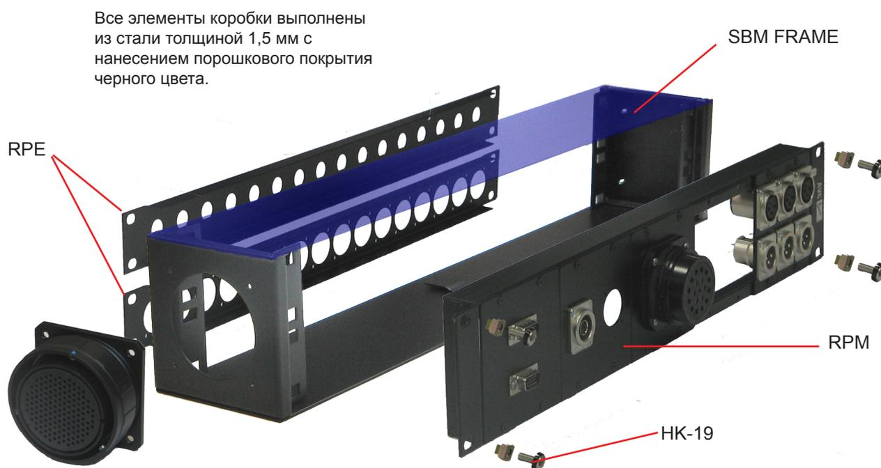
Одна из торцевых крышек коробки имеет монтажное отверстие для установки 85 или 150 контактного разъема. Размеры монтажного отверстия стандартные для большинства производителей многоконтактных круглых разъемов. В частности, могут быть использованы разъемы **Amphenol**, **Veam**.
