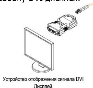
Рисунок 6 — Подключение приемного модуля к устройству отображения
