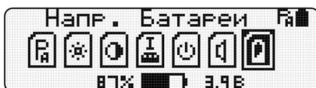
На дисплее в поле информации отображается текущее состояние аккумулятора в процентном соотношении и его напряжение.
