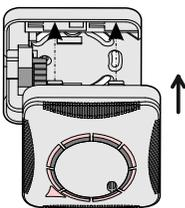
с небольшим усилием задвиньте извещатель по направлению стрелки до полной стыковки с базой
