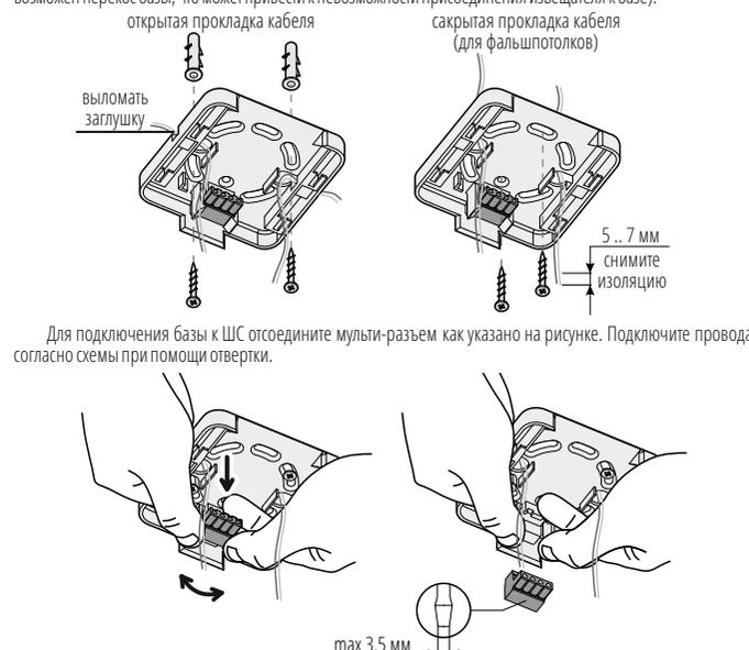
После подключения установите мульти-разъём в базу, аккуратно уложите все провода.
