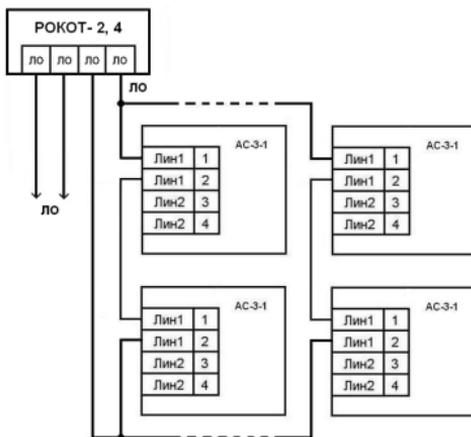
Рис.3 Схема подключения «АС-3-1» к приборам управления оповещением «Рокот-2, -4»
