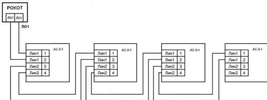
Рис.2 Схема подключения «АС-3-1» к прибору управления оповещением «Рокот»
