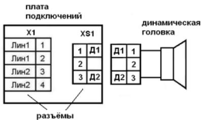
Рис.1 Структурная схема «АС-3-1»
