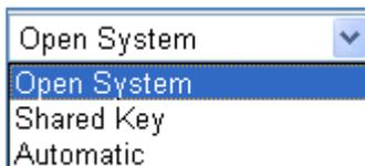
В меню **Идентификация** устанавливается режим аутентификации – **Open System** (Открытая система), **Shared key** (Разделяемый ключ) или **Automatic** (Автоматически).
