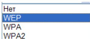
**Шифрование:** можно установить параметры шифрования для безопасности Wi-Fi подключения. Возможные значения – **Нет** (шифрование выключено), **WEP** – шифрование WEP, **WAP** – шифрование WAP, **WPA2** – шифрование WPA2.
