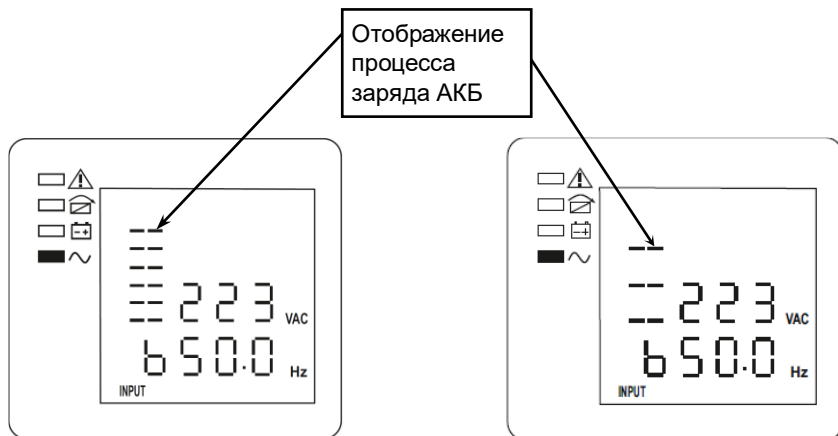
Рисунок 21 — ЖК-дисплей, форсированный (ускоренный) заряд АКБ
