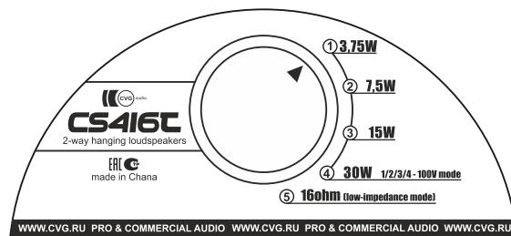
При выборе низкоомного режима недопустимо подключение акустических систем CS416T к трансляционному 100V усилителю. И наоборот, если Вы на селекторе мощностей на акустической системе выбрали определенную мощность в 100V режиме (первые четыре позиции селектора сверху-вниз), то в данном случае подключение должно быть строго к трансляционному 100V усилителю. При этом суммарная мощность акустических систем не должна превышать заявленную мощность усилителя.
