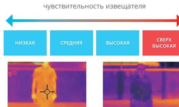
На объектах особой важности может использоваться режим сверхвысокой чувствительности, при котором извещатель даже в условиях слабой ИК видимости обнаружит минимальные температурные колебания и отправит сигнал тревоги.
