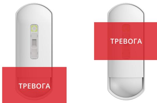
Один модуль системы антимаскирования контролирует состояние линзы, второй — верхнюю часть извещателя, где расположен СВЧ-датчик (FLX-A-DAM). Тревога срабатывает при 20-секундной блокировке одного из них.
