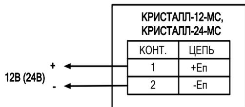
Рис.1. Схема подключения.
