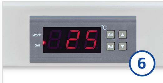
После включения нажмите кнопку **Set** один раз для ввода температуры срабатывания контроллера. При этом загорится световой индикатор.
