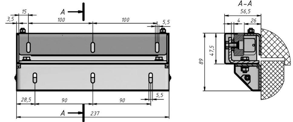
Рисунок 2 - Габаритный чертеж комплекта МК AL-200PR-Inside
