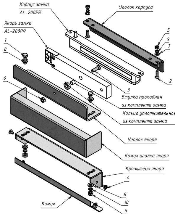
Рисунок 1 – Установка корпуса и якоря замка AL-200PR с комплектом МК AL-200PR-Inside
