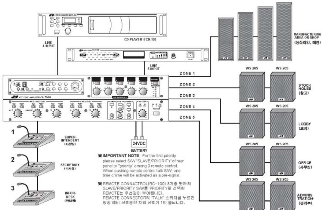
\* **Важное замечание:** Для выбора высшего приоритета одной из микрофонных консолей установите переключатель SLAVE/PRIORITY на задней панели нужной консоли в положении PRIORITY. При однократном нажатии клавиши на микрофонной консоли прозвучит предупреждающий сигнал.
