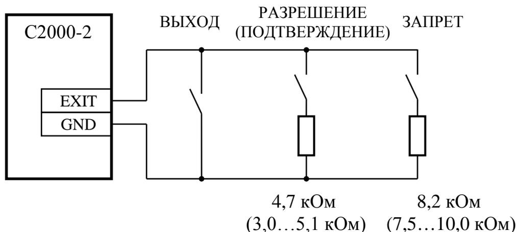
**Рисунок 5** Схема подключения кнопок "ВЫХОД", "РАЗРЕШЕНИЕ" и "ЗАПРЕТ"
