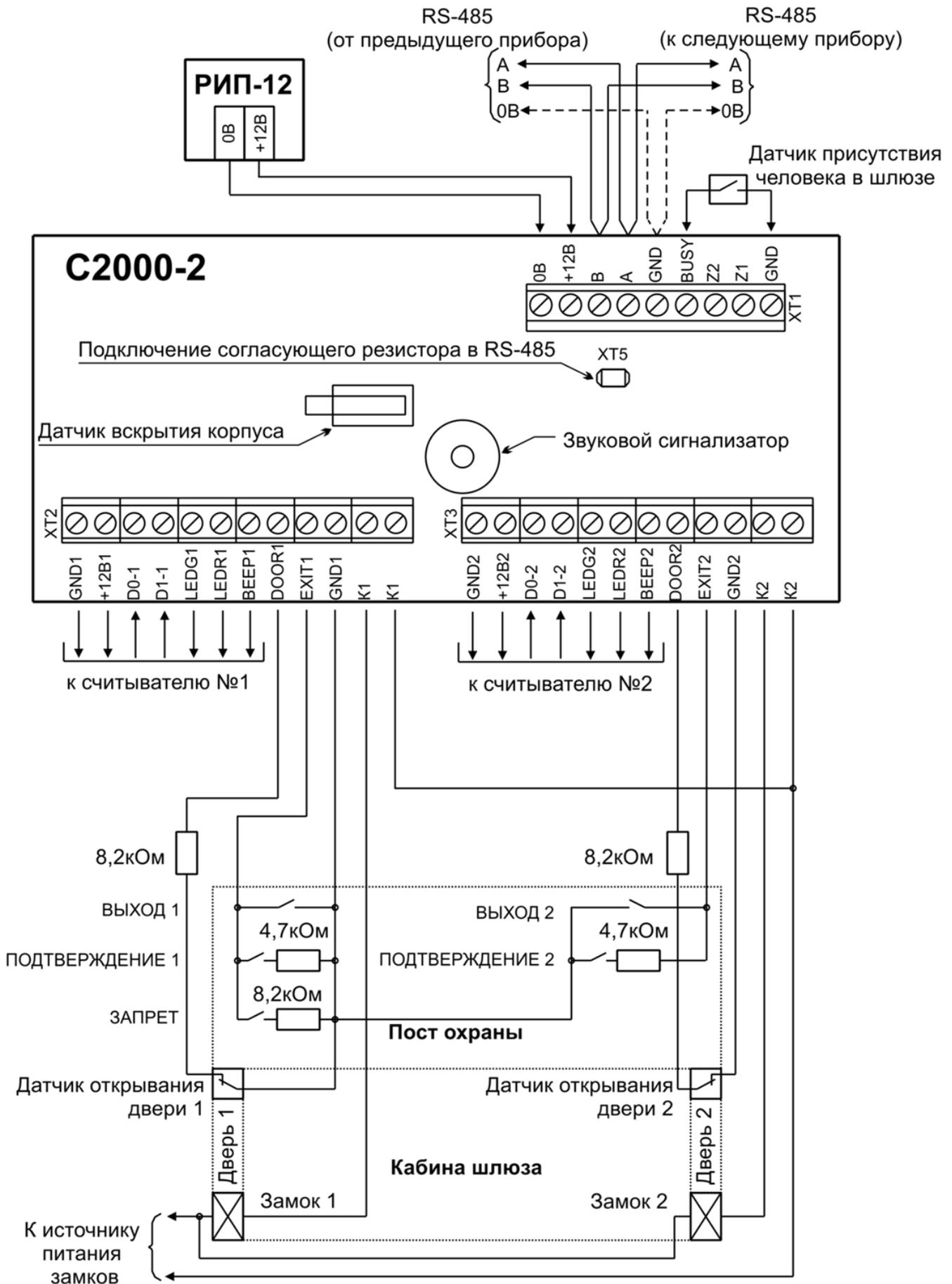
**Рисунок 16** Схема подключения контроллера "С2000-2" в режиме "Шлюз"
