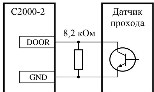
Рисунок 4 Схемы подключения датчика открывания двери (датчика прохода)
