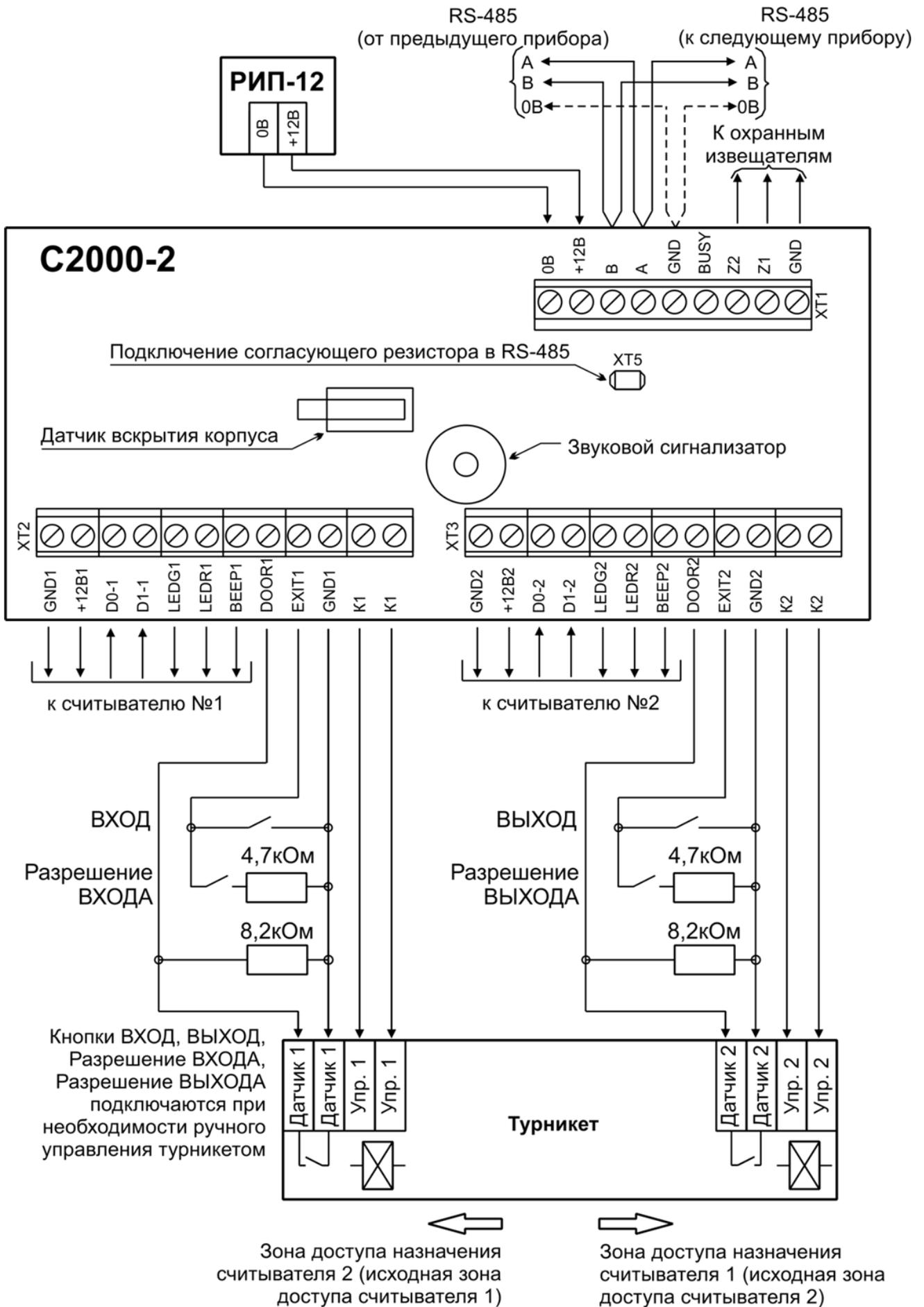
Рисунок 11 Схема подключения контроллера "С2000-2" в режиме "Турникет"
