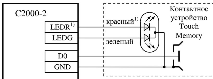
1) Если на контактном устройстве установлен одноцветный светодиод, то он независимо от цвета свечения подключается к контакту "LEDG" контроллера "C2000-2".
