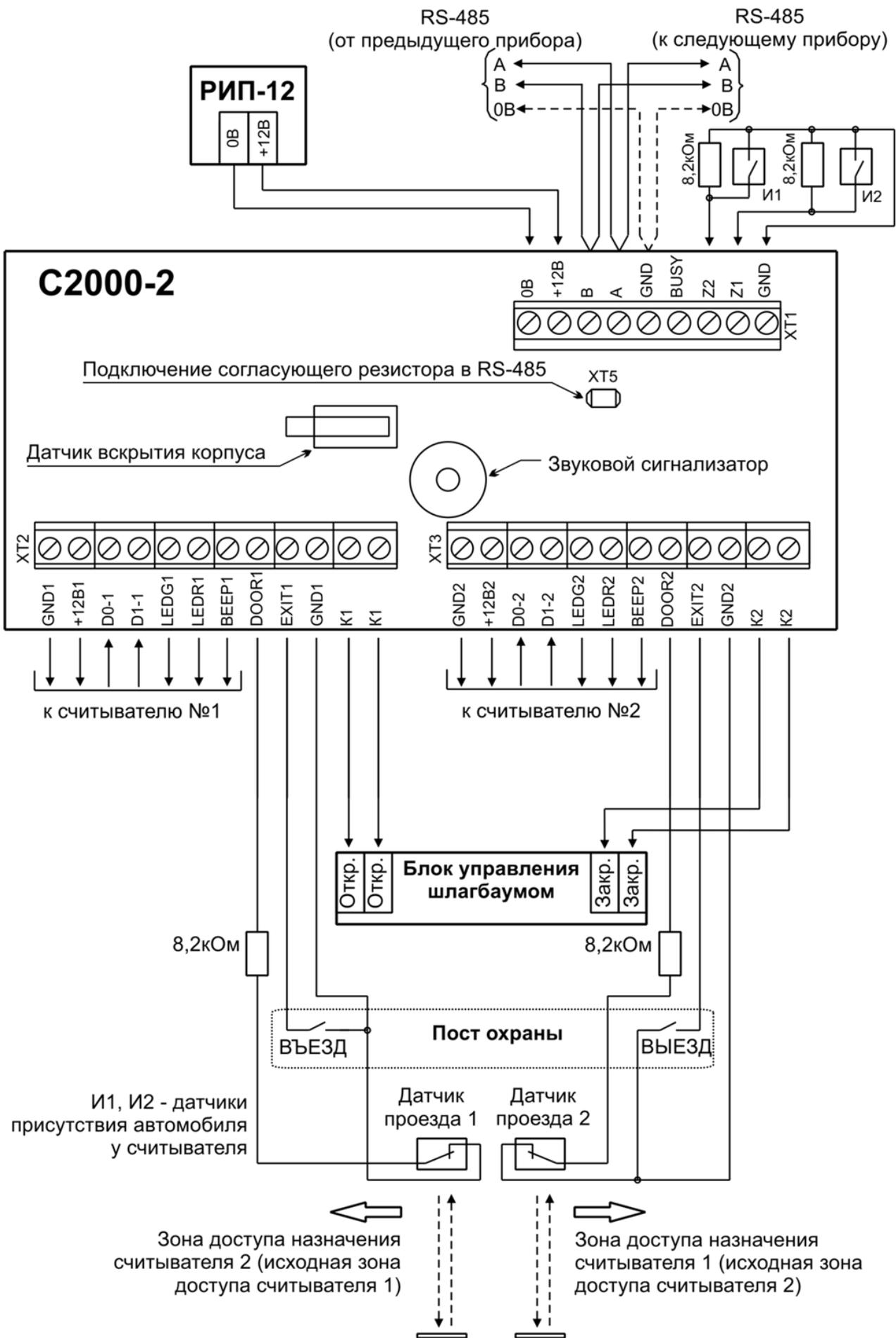
Рисунок 13 Схема подключения контроллера "С2000-2" в режиме "Шлагбаум"
