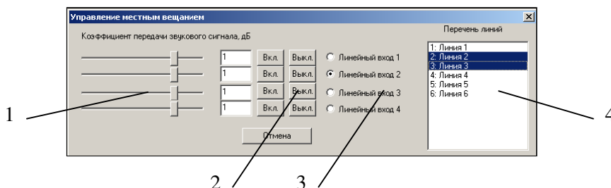
Рисунок 7.29. Диалоговое окно установки управления местным вещанием. 1 – органы управления громкостью, 2 – кнопки включения/выключения входов МВ, 3 – кнопки выбора входа для задания линий оповещения, 4 – список линий оповещения.
