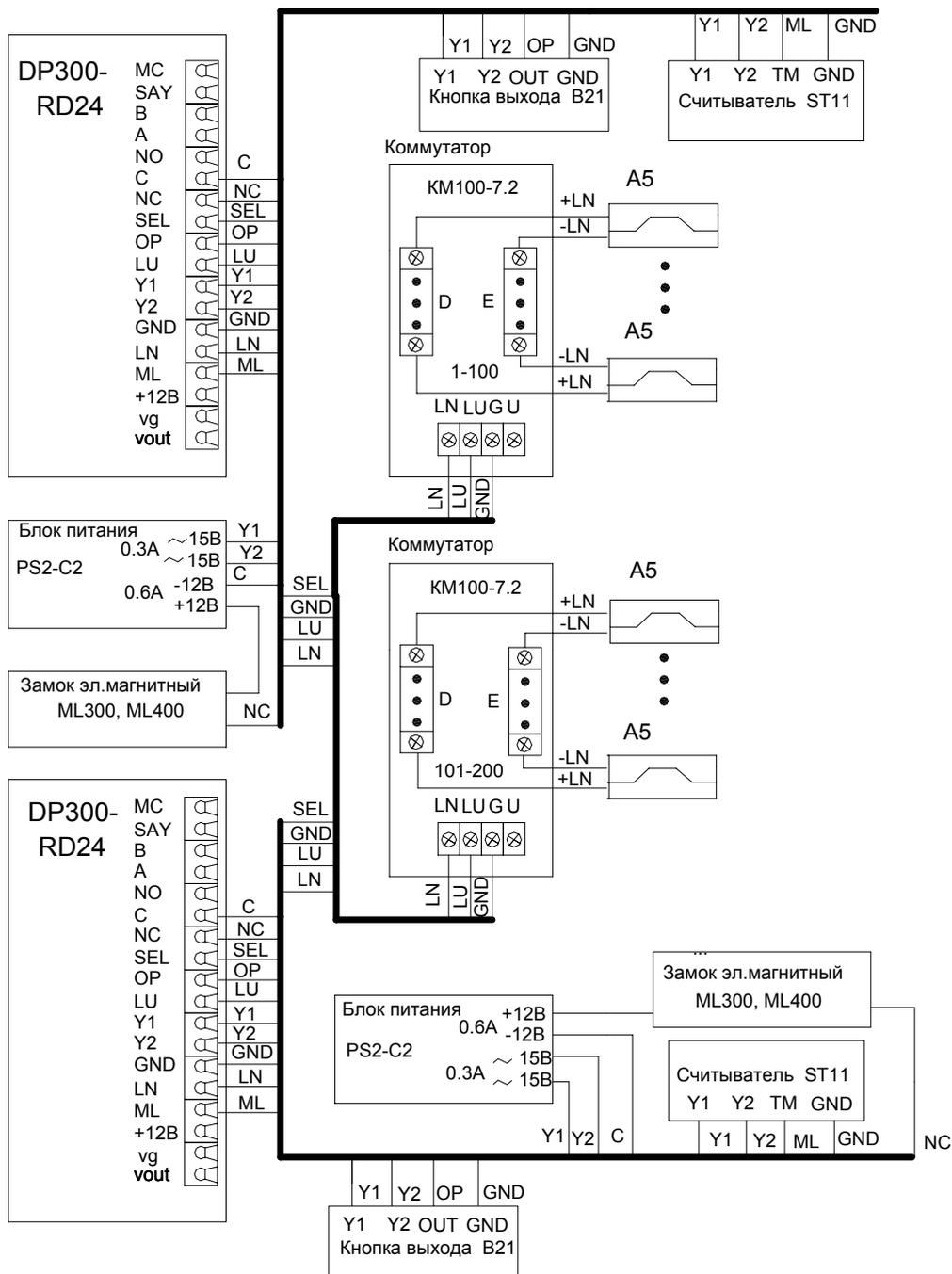
Пример схемы подключения DP300-RD24 в составе домофонного комплекса.
