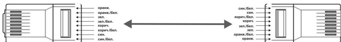
Рис. 4. Схема подключения вилки RJ45
