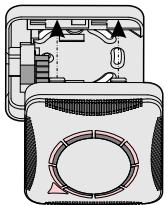
с небольшим усилием задвиньте извещатель по направлению стрелки до полной стыковки с базой
