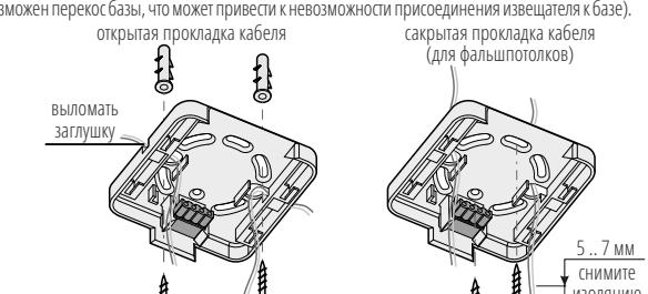
Для подключения базы к ШС отсоедините мульти-разъем как указано на рисунке. Подключите провода согласно схемы при помощи отвертки.
