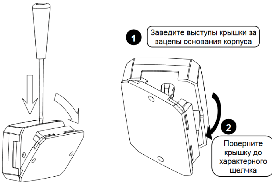
Рисунок 2.3. Снятие и установки крышки преобразователя
