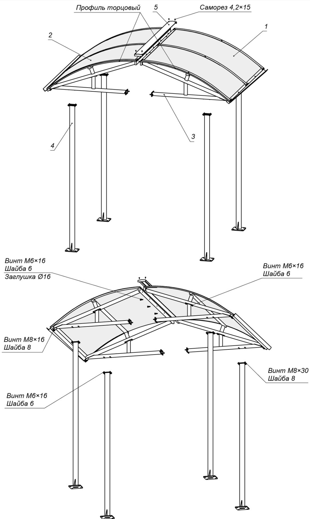
**Рисунок 2. Устройство крыши:**
