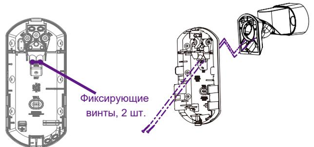
Для крепления кронштейна обычно требуется 3 отверстия и 3 соединительных винта. Если требуется более надежное крепление, используйте 2 дополнительных Фиксирующие винты.
