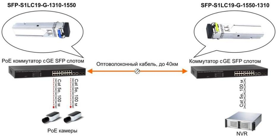
Рис.8 Типовая схема подключения SFP модулей SFP-S1LC19-G-1310-1550, SFP-S1LC19-G-1550-1310
