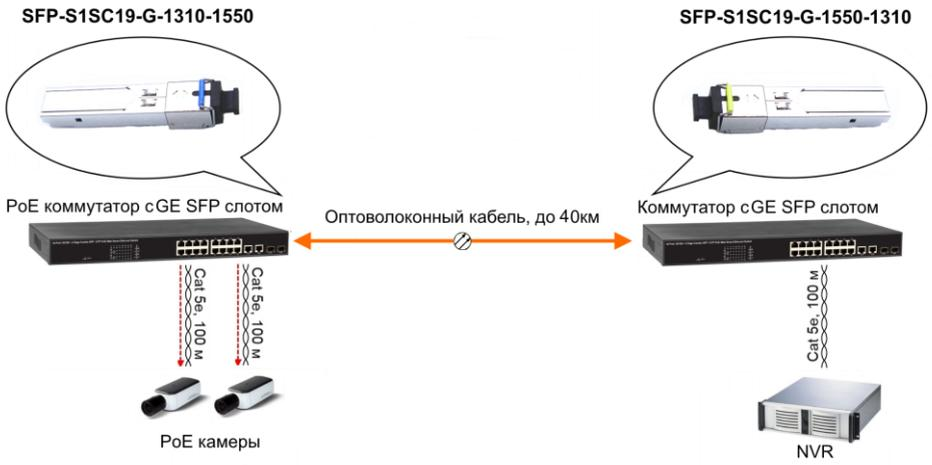
Рис.6 Типовая схема подключения SFP модулей SFP-S1SC19-G-1310-1550, SFP-S1SC19-G-1550-1310
