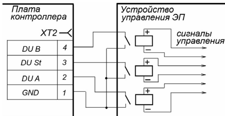
Рисунок 7. Управляющие элементы устройства управления ЭП:
