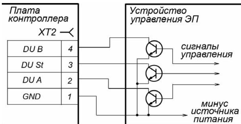
Рисунок 8. Управляющие элементы устройства управления ЭП:
