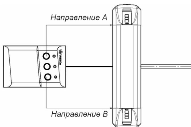
Рисунок 6. Стандартная ориентация ПДУ относительно стойки ЭП
