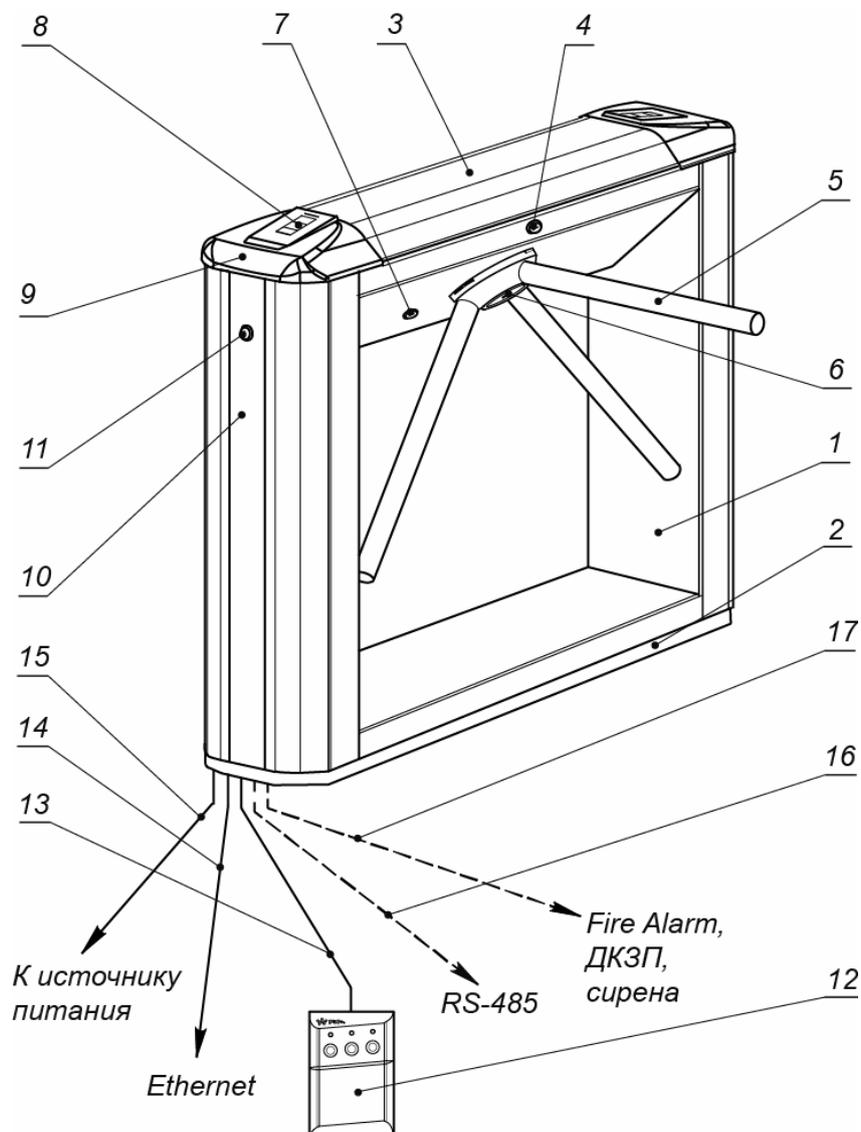
**Рисунок 2. Устройство ЭП**
