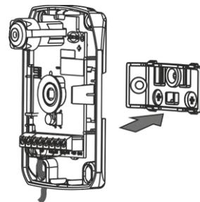
**5** Закрепить подведенные провода в клеммах извещателя:
