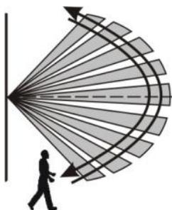
Повторить **ТЕСТ-проход** в обратном направлении. Зоны чувствительности, формируемые линзой, будут расположены посередине между отмеченными положениями. Проконтролировать выдачу извещения «Тревога-ИК» на приемно-контрольном приборе
