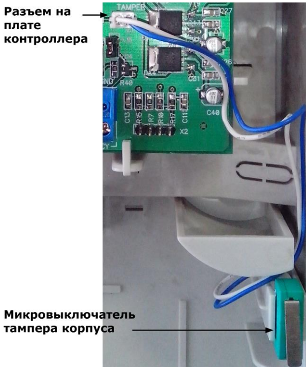
Рисунок 23. Подключение тампера корпуса
