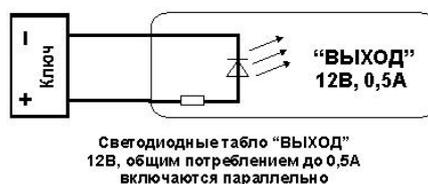
Рис. 5 Подключение табло «ВЫХОД» или светильников аварийного освещения
