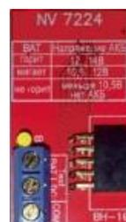
**NV 7224** Модуль контроля и защиты АКБ
