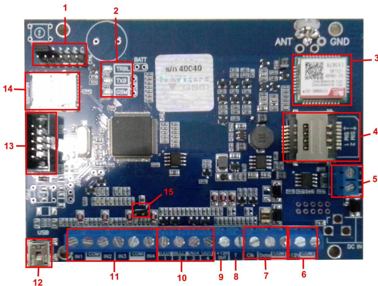
1 – группа перемычек 123ABC. Используются для выбора режима индикации, для сброса настроек и обнуления буфера событий. В обычном состоянии все перемычки должны быть сняты
