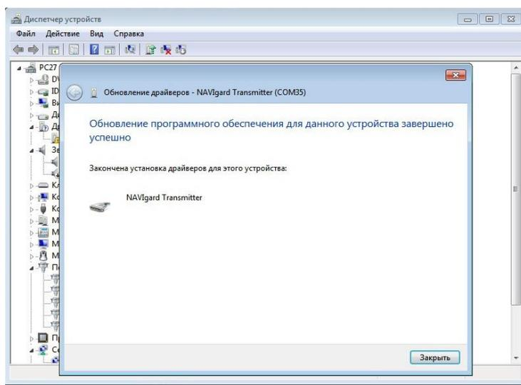
6. Нажмите Закреть. В разделе Порты (COM и LPT) появится устройство NAVIgard Transmitter. Запомните номер порта и используйте его в программах для связи с передатчиком.
