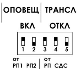
Режим ОПОВЕЩЕНИЕ предусматривает включение реле, осуществляющее обход регулятора громкости в АС при трёхпроводной системе разводки, а также подключение выхода усилителя на момент работы РП1 или РП2.
