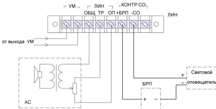
Акустические системы, имеющие в своём составе регулятор громкости, подключаются, как показано на рисунке. Двухпроводные АС подключаются к клеммам ОБЩ и ТР.
