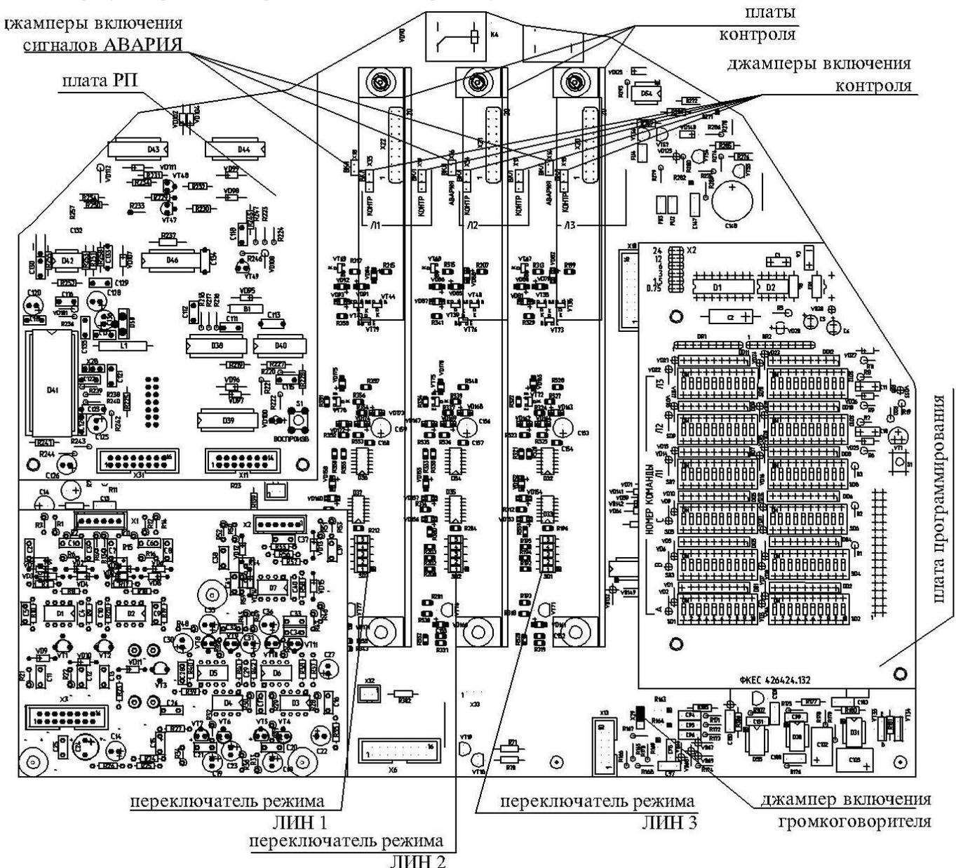
Установите режим запуска автоматического контроля линий оповещения джампером на плате программирования. Дискретная установка предусматривает интервалы контроля: 0,75ч; 1,5ч; 3ч; 6ч; 12ч; 24 ч. Заводская установка – 12ч
