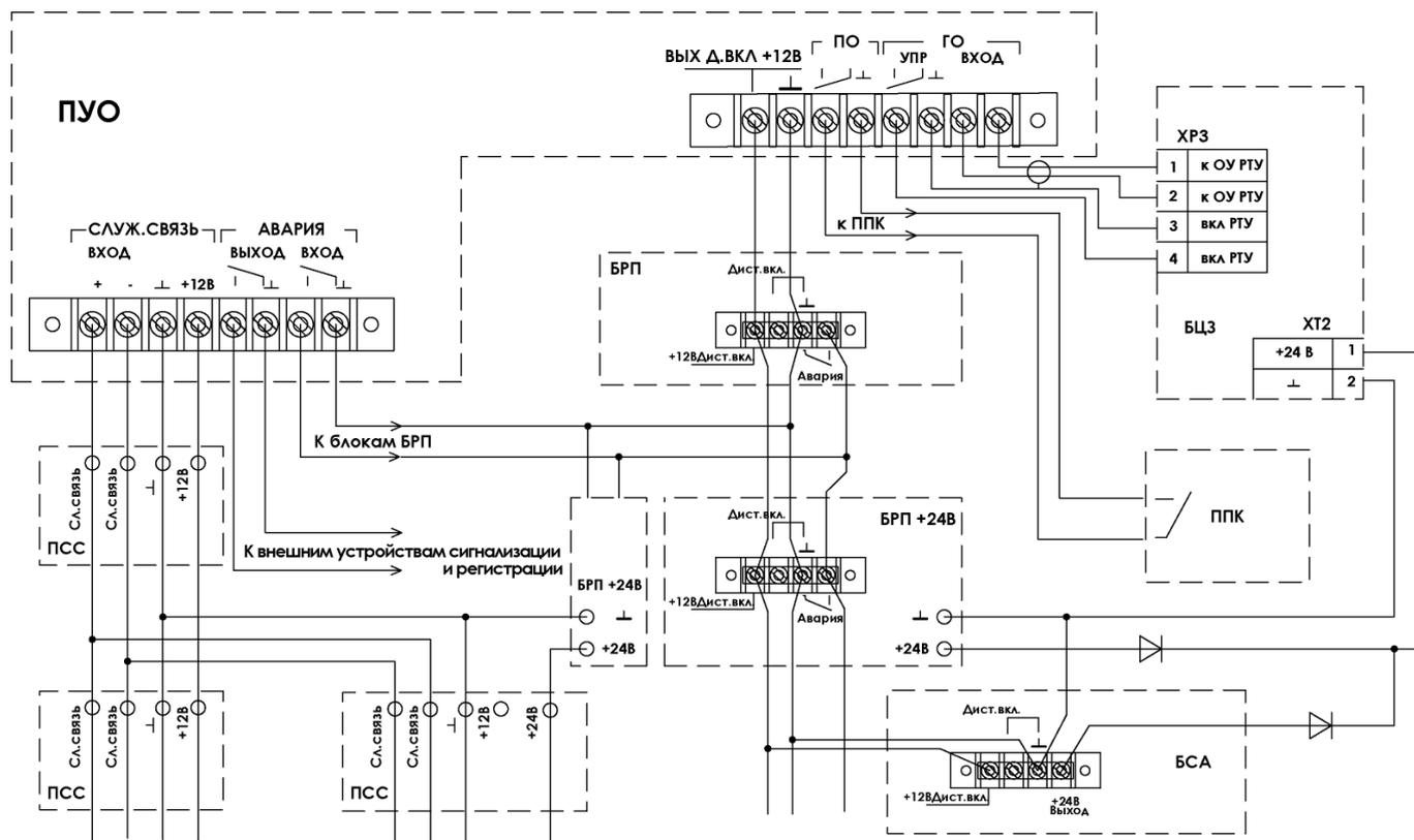
ПСС подключаются по питанию к клеммам «+12В» и «⊥», однако более 3х ПСС к ПУО включать не рекомендуется по причине недостаточной для этого емкости аккумулятора ПУО при работе без сетевого питания.
