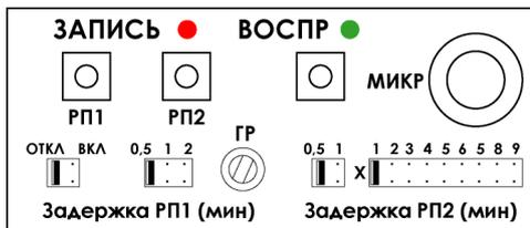
В блоке может быть установлена задержка включения автоматического речевого оповещения при пожаре установкой джампера ЗАДЕРЖКА РП1 в положение ВКЛ. Задержка имеет 3 фиксированных значения - 0,5; 1 и 2 минуты, которые также устанавливаются джампером.
