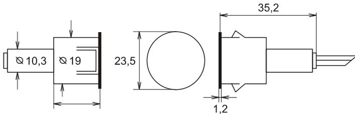
1.1.Извещатель охранный точечный магнитоcontactный переключающий ИО 102-6 П (далее – извещатель) предназначен для блокировки металлических дверных и оконных проёмов, сейфов, организации устройств типа «ловушка», а также блокировки других конструктивных элементов зданий и сооружений на открывание или смещение с выдачей сигнала «тревога» путём переключения контактов геркона на приёмно-контрольный прибор, концентратор или пункт централизованного наблюдения.
