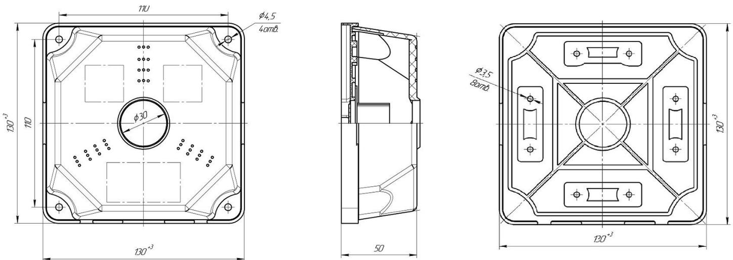
Рис. 1. Габаритные и присоединительные размеры КМ-1
