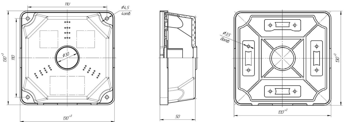
Рис. 1. Габаритные и присоединительные размеры КМ-1
