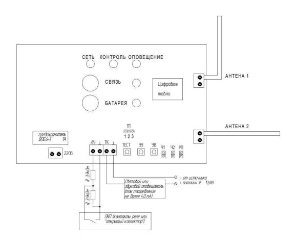
Рисунок-1 Схема подключений прибора Соната-Р
