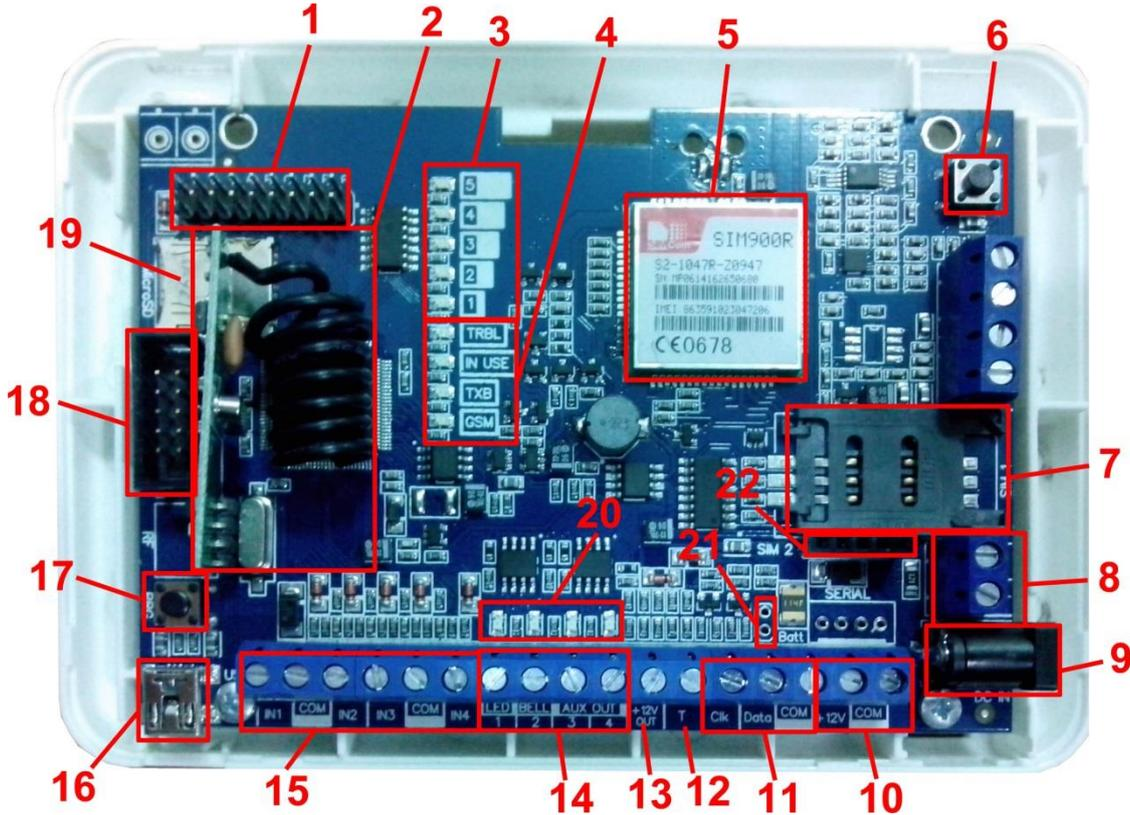
1 – группа перемычек. Используются для выбора режима индикации, сброса настроек, обнуления буфера событий и программирования ключей ТМ. В обычном состоянии все перемычки должны быть сняты.
