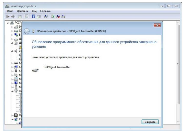
6. Нажмите Закрывать. В разделе Порты (COM и LPT) появится устройство NAVIgard Transmitter. Запомните номер порта и используйте его в программах для связи с передатчиком.
